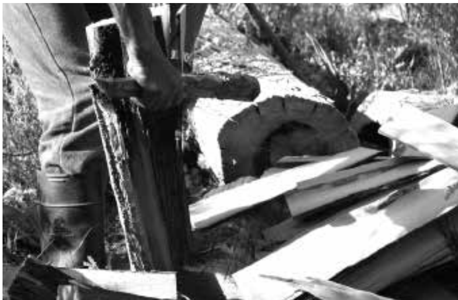
Fotografía 4. Maestro tejuelero en acción (ciprés de las Guaitecas). Fuente: de la autora.
